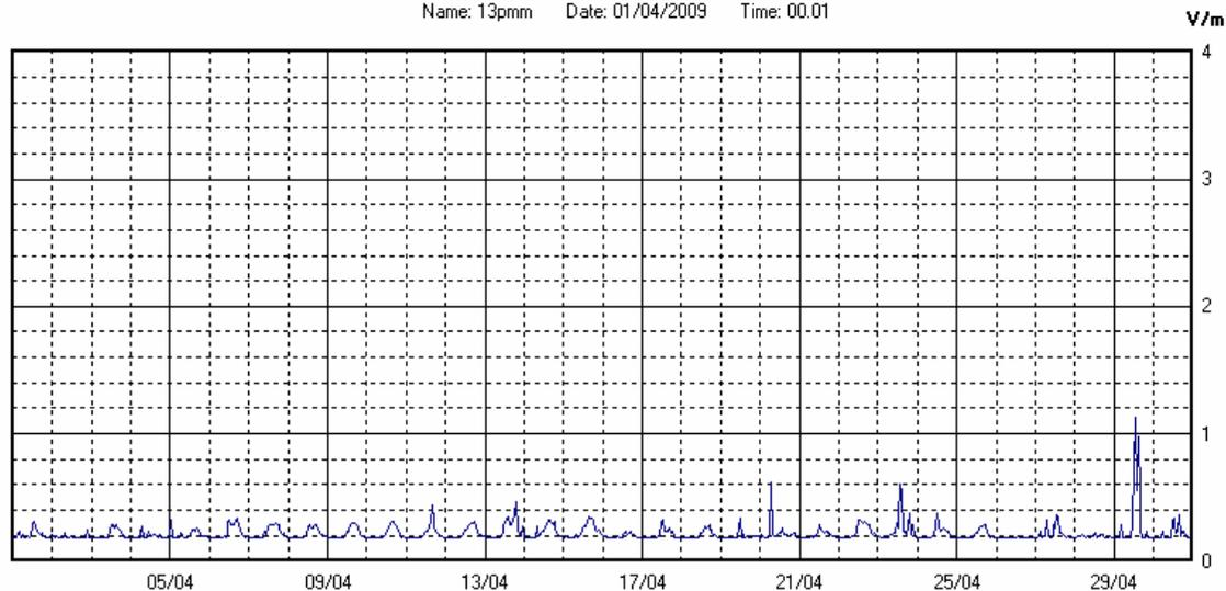
Il parametro misurato è il campo elettrico (E) e la sua unità di misura è il Volt/metro (V/m). In tabella si riporta il valore medio massimo (E<sub>max</sub>) riferito a un intervallo di tempo di 6 minuti; l'andamento della linea blu descrive l'evoluzione del campo elettromagnetico nell'arco dell'intera settimana. Nell'asse delle ascisse sono riportati i giorni, nelle ordinate il valore di campo elettromagnetico misurato in V/m.
