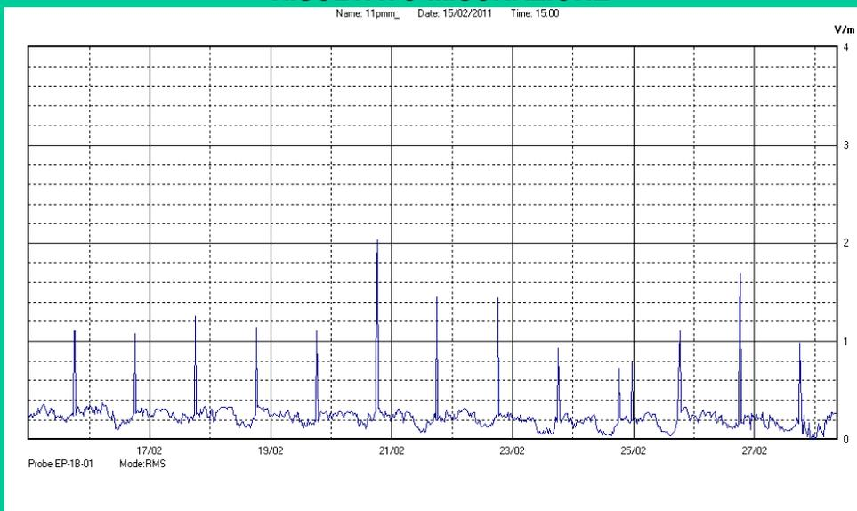
Il parametro misurato è il campo elettrico (E) e la sua unità di misura è il Volt/metro (V/m). In tabella si riporta il valore medio massimo (Emax) riferito a un intervallo di tempo di 6 minuti; l'andamento della linea blu descrive l'evoluzione del campo elettromagnetico nell'arco dell'intera settimana. Nell'asse delle ascisse sono riportati i giorni, nelle ordinate il valore di campo elettromagnetico misurato in V/m.
