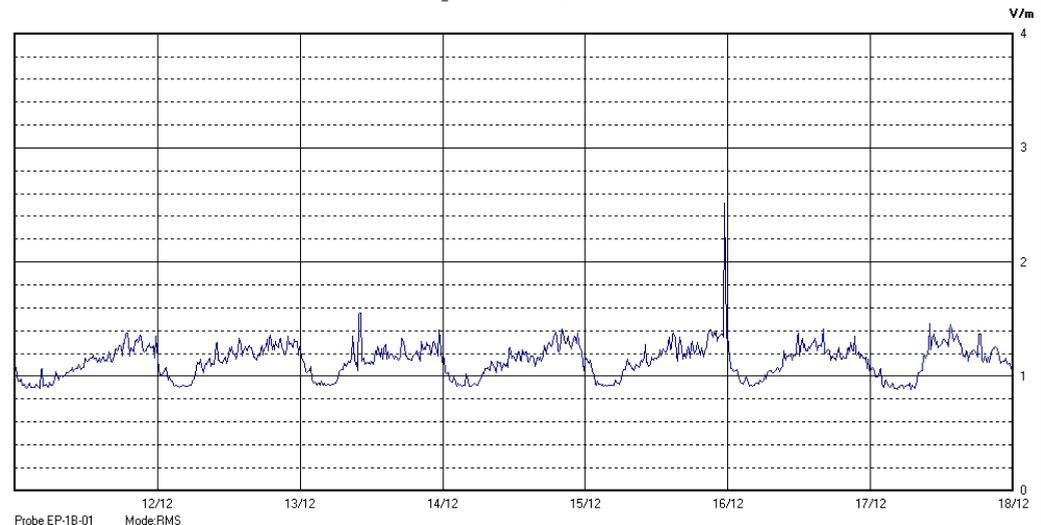
Il parametro misurato è il campo elettrico (E) e la sua unità di misura è il Volt/metro (V/m). In tabella si riporta il valore medio massimo (E<sub>max</sub>) riferito a un intervallo di tempo di 6 minuti; l'andamento della linea blu descrive l'evoluzione del campo elettromagnetico nell'arco dell'intera settimana. Nell'asse delle ascisse sono riportate le ore dei giorni monitorati, nelle ordinate il valore di campo elettromagnetico misurato in V/m.
