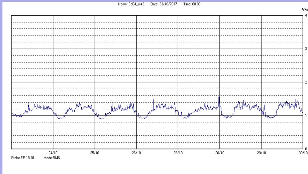
Il parametro misurato è il campo elettrico (E) e la sua unità di misura è il Volt/metro (V/m). In tabella si riporta il valore medio massimo (E<sub>max</sub>) riferito a un intervallo di tempo di 6 minuti; l'andamento della linea blu descrive l'evoluzione del campo elettromagnetico nell'arco dell'intera settimana. Nell'asse delle ascisse sono riportate le ore dei giorni monitorati, nelle ordinate il valore di campo elettromagnetico misurato in V/m.
