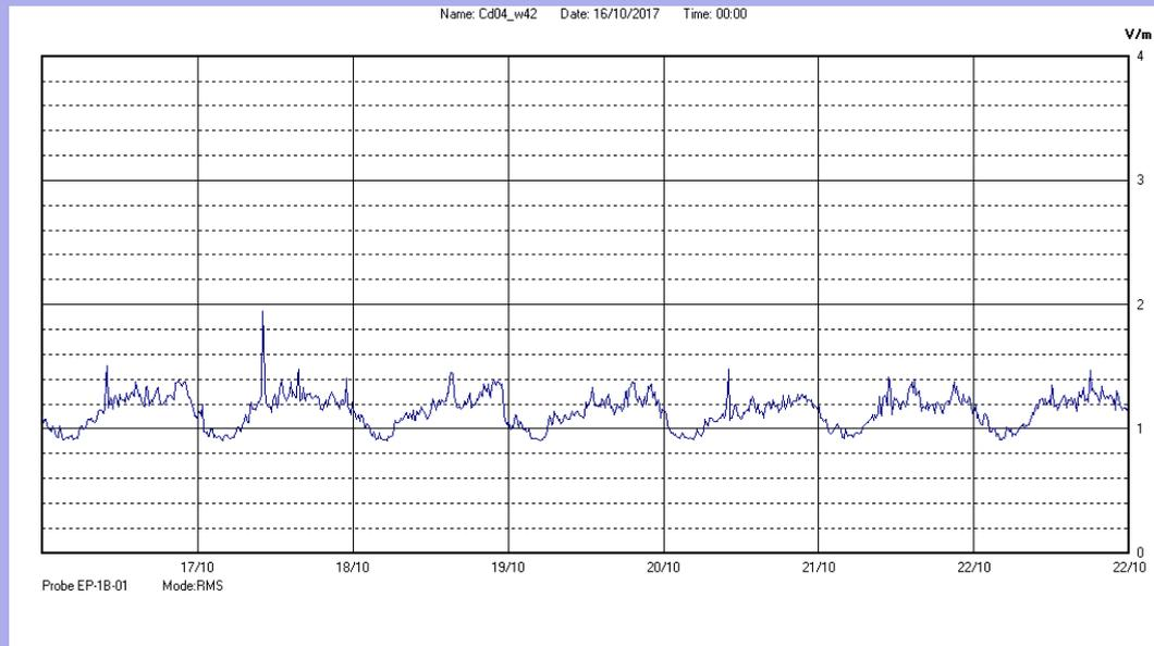
Il parametro misurato è il campo elettrico (E) e la sua unità di misura è il Volt/metro (V/m). In tabella si riporta il valore medio massimo (E<sub>max</sub>) riferito a un intervallo di tempo di 6 minuti; l'andamento della linea blu descrive l'evoluzione del campo elettromagnetico nell'arco dell'intera settimana. Nell'asse delle ascisse sono riportate le ore dei giorni monitorati, nelle ordinate il valore di campo elettromagnetico misurato in V/m.
