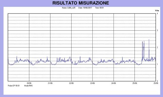
Il parametro misurato è il campo elettrico (E) e la sua unità di misura è il Volt/metro (V/m). In tabella si riporta il valore medio massimo (Emax) riferito a un intervallo di tempo di 6 minuti; l'andamento della linea blu descrive l'evoluzione del campo elettromagnetico nell'arco dell'intera settimana. Nell'asse delle ascisse sono riportate le ore dei giorni monitorati, nelle ordinate il valore di campo elettromagnetico misurato in V/m.
