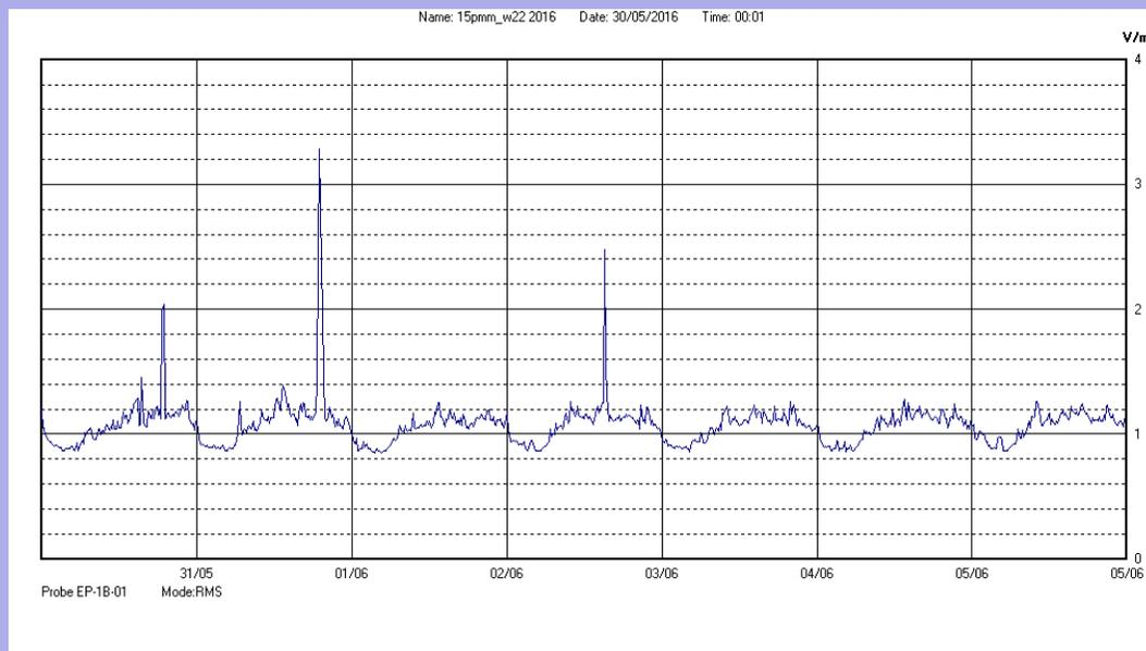
Il parametro misurato è il campo elettrico (E) e la sua unità di misura è il Volt/metro (V/m). In tabella si riporta il valore medio massimo (Emax) riferito a un intervallo di tempo di 6 minuti; l'andamento della linea blu descrive l'evoluzione del campo elettromagnetico nell'arco dell'intera settimana. Nell'asse delle ascisse sono riportate le ore dei giorni monitorati, nelle ordinate il valore di campo elettromagnetico misurato in V/m.
