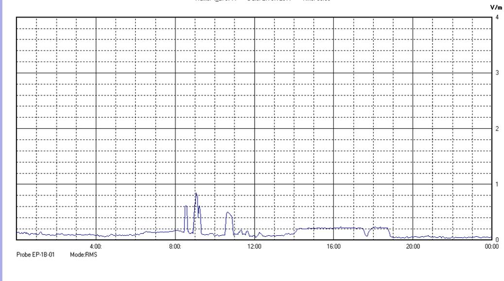
Il parametro misurato è il campo elettrico (E) e la sua unità di misura è il Volt/metro (V/m). In tabella si riporta il valore medio massimo (Emax) riferito a un intervallo di tempo di 6 minuti; l'andamento della linea blu descrive l'evoluzione del campo elettromagnetico nell'arco dell'intero giorno. Nell'asse delle ascisse sono riportate le ore del giorno monitorato, nelle ordinate il valore di campo elettromagnetico misurato in V/m.
