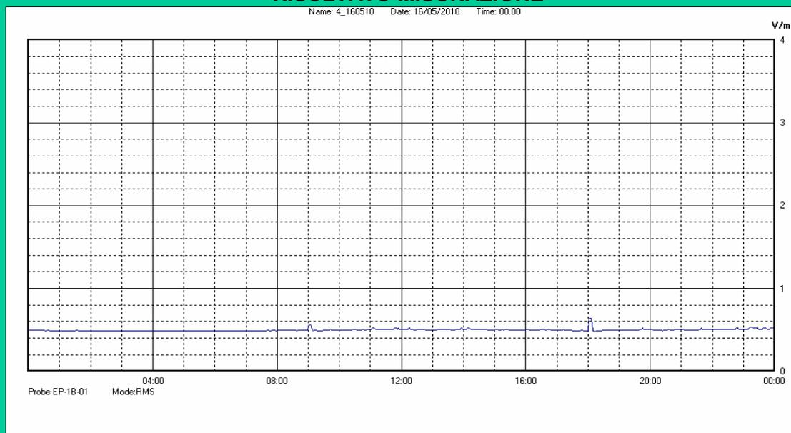
Il parametro misurato è il campo elettrico (E) e la sua unità di misura è il Volt/metro (V/m). In tabella si riporta il valore medio massimo (E<sub>max</sub>) riferito a un intervallo di tempo di 6 minuti; l'andamento della linea blu descrive l'evoluzione del campo elettromagnetico nell'arco dell'intera settimana. Nell'asse delle ascisse sono riportati i giorni, nelle ordinate il valore di campo elettromagnetico misurato in V/m.
