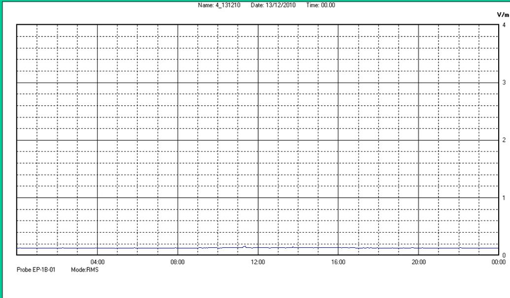
Il parametro misurato è il campo elettrico (E) e la sua unità di misura è il Volt/metro (V/m). In tabella si riporta il valore medio massimo (E<sub>max</sub>) riferito a un intervallo di tempo di 6 minuti; l'andamento della linea blu descrive l'evoluzione del campo elettromagnetico nell'arco dell'intera settimana. Nell'asse delle ascisse sono riportati i giorni, nelle ordinate il valore di campo elettromagnetico misurato in V/m.
