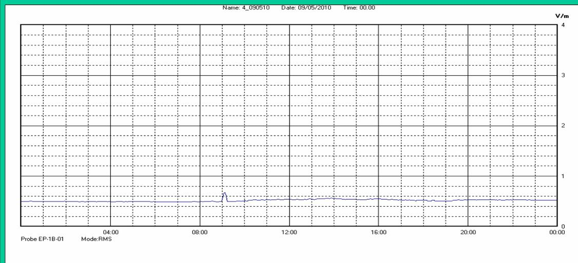
Il parametro misurato è il campo elettrico (E) e la sua unità di misura è il Volt/metro (V/m). In tabella si riporta il valore medio massimo (E<sub>max</sub>) riferito a un intervallo di tempo di 6 minuti; l'andamento della linea blu descrive l'evoluzione del campo elettromagnetico nell'arco dell'intera settimana. Nell'asse delle ascisse sono riportati i giorni, nelle ordinate il valore di campo elettromagnetico misurato in V/m.
