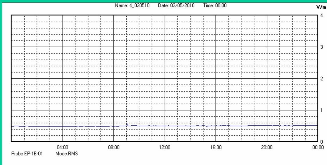
Il parametro misurato è il campo elettrico (E) e la sua unità di misura è il Volt/metro (V/m). In tabella si riporta il valore medio massimo (E<sub>max</sub>) riferito a un intervallo di tempo di 6 minuti; l'andamento della linea blu descrive l'evoluzione del campo elettromagnetico nell'arco dell'intera settimana. Nell'asse delle ascisse sono riportati i giorni, nelle ordinate il valore di campo elettromagnetico misurato in V/m.
