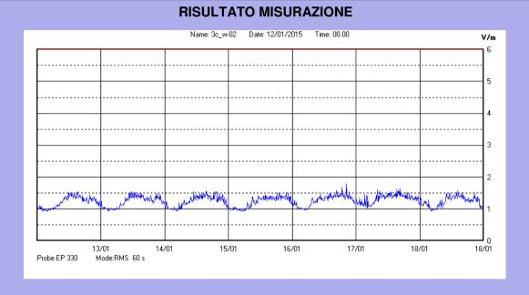
Il parametro misurato è il campo elettrico (E) e la sua unità di misura è il Volt/metro (V/m). In tabella si riporta il valore medio massimo (Emax) riferito a un intervallo di tempo di 6 minuti; l'andamento della linea blu descrive l'evoluzione del campo elettromagnetico nell'arco dell'intera settimana. Nell'asse delle ascisse sono riportate le ore dei giorni monitorati, nelle ordinate il valore di campo elettromagnetico misurato in V/m.
