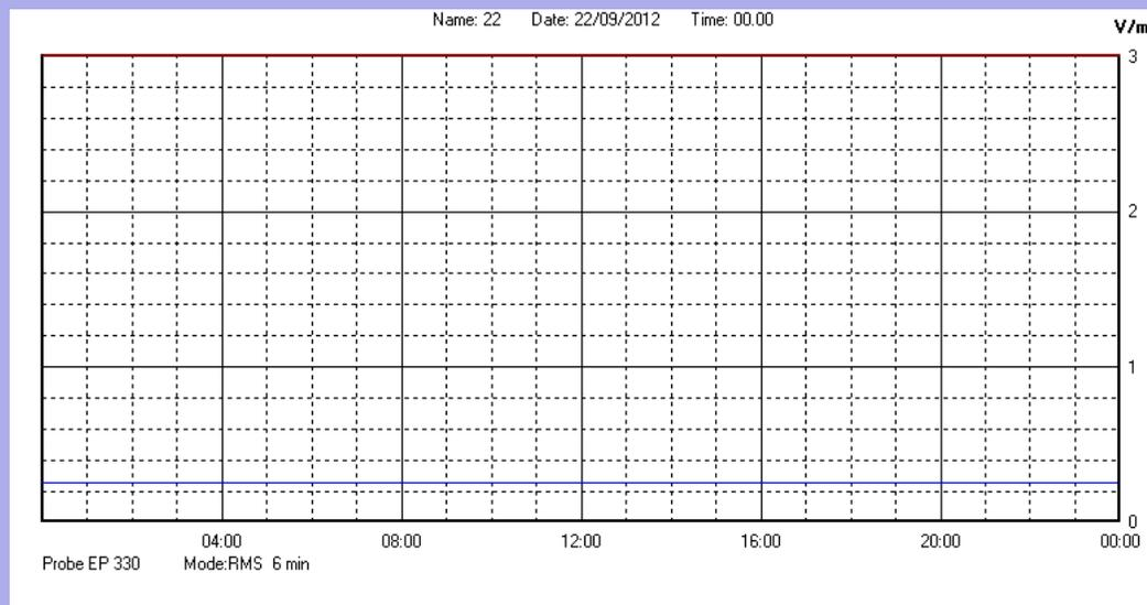
Il parametro misurato è il campo elettrico (E) e la sua unità di misura è il Volt/metro (V/m). In tabella si riporta il valore medio massimo (E<sub>max</sub>) riferito a un intervallo di tempo di 6 minuti; l'andamento della linea blu descrive l'evoluzione del campo elettromagnetico nell'arco dell'intero giorno. Nell'asse delle ascisse sono riportate le ore del giorno monitorato, nelle ordinate il valore di campo elettromagnetico misurato in V/m.
