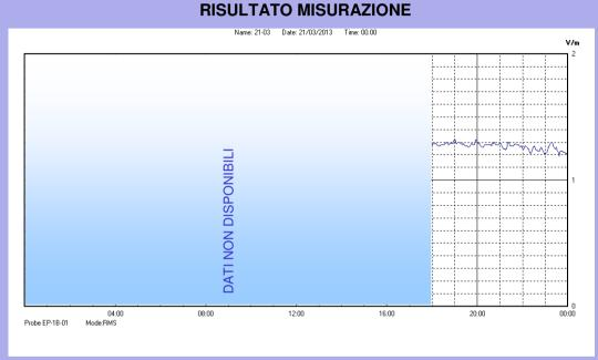
Il parametro misurato è il campo elettrico (E) e la sua unità di misura è il Volt/metro (V/m). In tabella si riporta il valore medio massimo (Emax) riferito a un intervallo di tempo di 6 minuti; l'andamento della linea blu descrive l'evoluzione del campo elettromagnetico nell'arco dell'intero giorno. Nell'asse delle ascisse sono riportate le ore del giorno monitorato, nelle ordinate il valore di campo elettromagnetico misurato in V/m.
