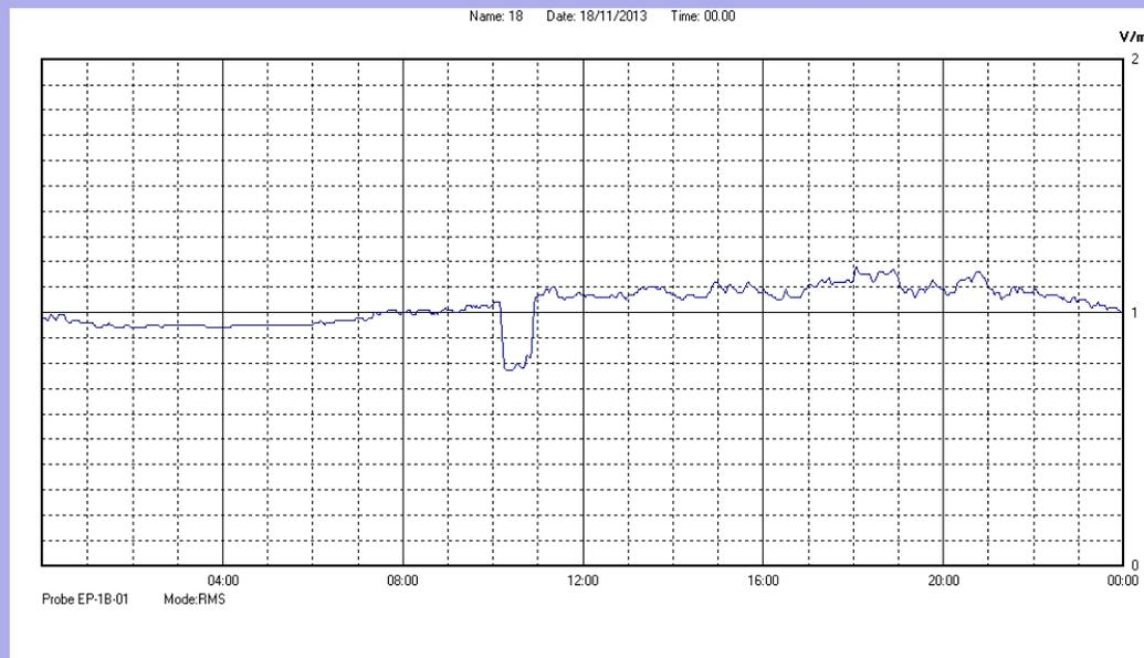
Il parametro misurato è il campo elettrico (E) e la sua unità di misura è il Volt/metro (V/m). In tabella si riporta il valore medio massimo (Emax) riferito a un intervallo di tempo di 6 minuti; l'andamento della linea blu descrive l'evoluzione del campo elettromagnetico nell'arco dell'intero giorno. Nell'asse delle ascisse sono riportate le ore del giorno monitorato, nelle ordinate il valore di campo elettromagnetico misurato in V/m.
