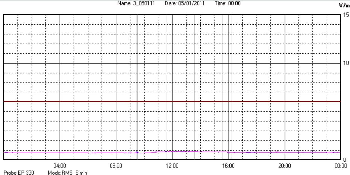
Il parametro misurato è il campo elettrico (E) e la sua unità di misura è il Volt/metro (V/m). In tabella si riporta il valore medio massimo (Emax) riferito a un intervallo di tempo di 6 minuti; l'andamento della linea blu descrive l'evoluzione del campo elettromagnetico nell'arco dell'intera settimana. Nell'asse delle ascisse sono riportati i giorni, nelle ordinate il valore di campo elettromagnetico misurato in V/m.
