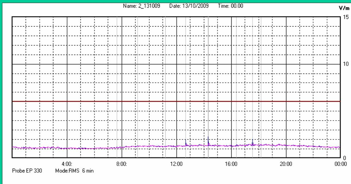
Il parametro misurato è il campo elettrico (E) e la sua unità di misura è il Volt/metro (V/m). In tabella si riporta il valore medio massimo (E<sub>max</sub>) riferito a un intervallo di tempo di 6 minuti; l'andamento della linea blu descrive l'evoluzione del campo elettromagnetico nell'arco dell'intera settimana. Nell'asse delle ascisse sono riportati i giorni, nelle ordinate il valore di campo elettromagnetico misurato in V/m.
