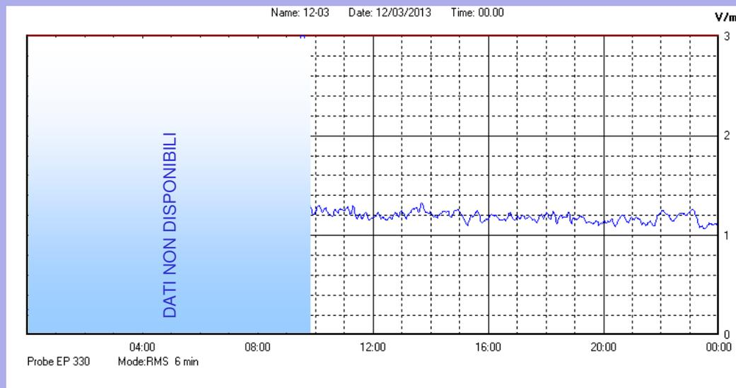
Il parametro misurato è il campo elettrico (E) e la sua unità di misura è il Volt/metro (V/m). In tabella si riporta il valore medio massimo (Emax) riferito a un intervallo di tempo di 6 minuti; l'andamento della linea blu descrive l'evoluzione del campo elettromagnetico nell'arco dell'intero giorno. Nell'asse delle ascisse sono riportate le ore del giorno monitorato, nelle ordinate il valore di campo elettromagnetico misurato in V/m.
