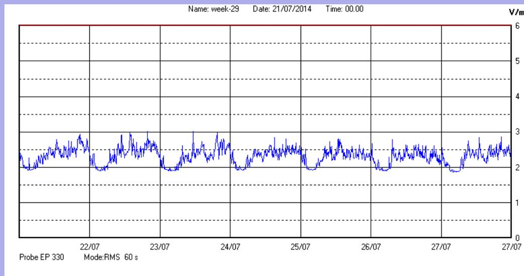
Il parametro misurato è il campo elettrico (E) e la sua unità di misura è il Volt/metro (V/m). In tabella si riporta il valore medio massimo (E<sub>max</sub>) riferito a un intervallo di tempo di 6 minuti; l'andamento della linea blu descrive l'evoluzione del campo elettromagnetico nell'arco dell'intera settimana. Nell'asse delle ascisse sono riportate le ore dei giorni monitorati, nelle ordinate il valore di campo elettromagnetico misurato in V/m.
