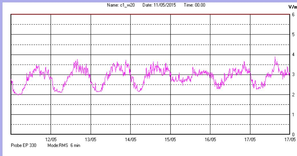
Il parametro misurato è il campo elettrico (E) e la sua unità di misura è il Volt/metro (V/m). In tabella si riporta il valore medio massimo (Emax) riferito a un intervallo di tempo di 6 minuti; l'andamento della linea blu descrive l'evoluzione del campo elettromagnetico nell'arco dell'intera settimana. Nell'asse delle ascisse sono riportate le ore dei giorni monitorati, nelle ordinate il valore di campo elettromagnetico misurato in V/m.
