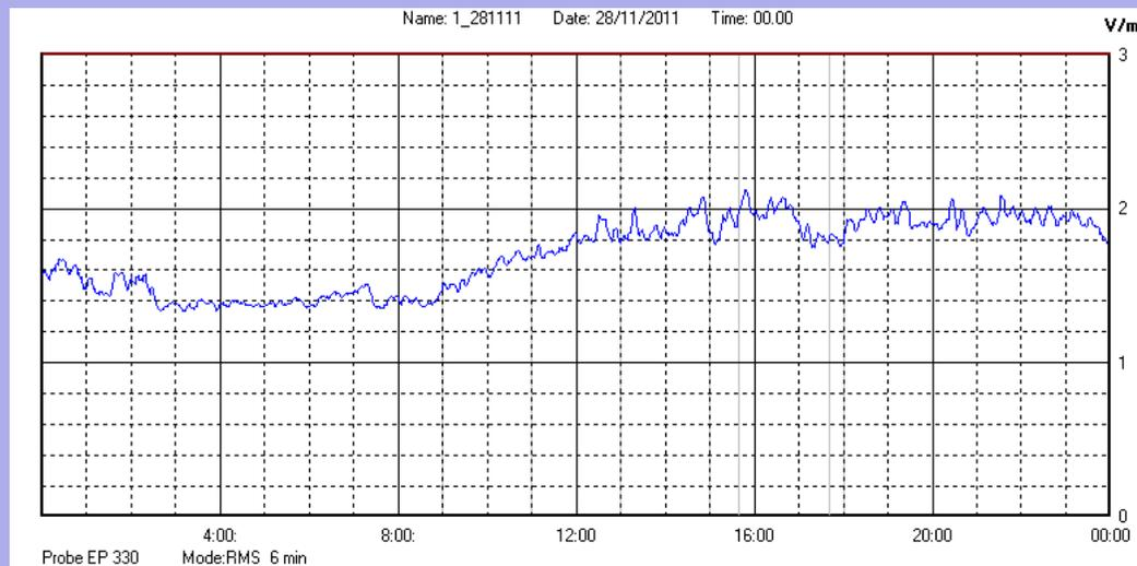
Il parametro misurato è il campo elettrico (E) e la sua unità di misura è il Volt/metro (V/m). In tabella si riporta il valore medio massimo (Emax) riferito a un intervallo di tempo di 6 minuti; l'andamento della linea blu descrive l'evoluzione del campo elettromagnetico nell'arco dell'intero giorno. Nell'asse delle ascisse sono riportate le ore del giorno monitorato, nelle ordinate il valore di campo elettromagnetico misurato in V/m.
