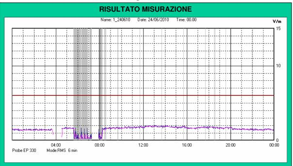
Il parametro misurato è il campo elettrico (E) e la sua unità di misura è il Volt/metro (V/m). In tabella si riporta il valore medio massimo (Emax) riferito a un intervallo di tempo di 6 minuti; l'andamento della linea blu descrive l'evoluzione del campo elettromagnetico nell'arco dell'intera settimana. Nell'asse delle ascisse sono riportati i giorni, nelle ordinate il valore di campo elettromagnetico misurato in V/m.
