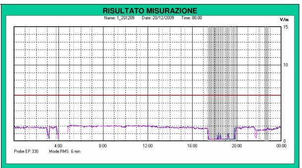
Il parametro misurato è il campo elettrico (E) e la sua unità di misura è il Volt/metro (V/m). In tabella si riporta il valore medio massimo (Emax) riferito a un intervallo di tempo di 6 minuti; l'andamento della linea blu descrive l'evoluzione del campo elettromagnetico nell'arco dell'intera settimana. Nell'asse delle ascisse sono riportati i giorni, nelle ordinate il valore di campo elettromagnetico misurato in V/m.
