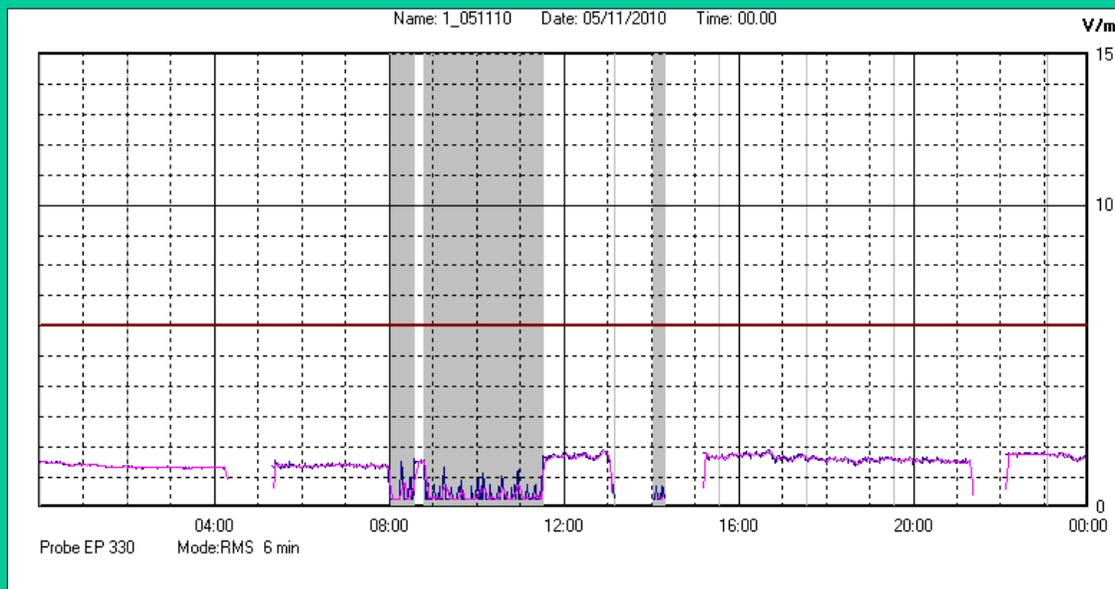
Il parametro misurato è il campo elettrico (E) e la sua unità di misura è il Volt/metro (V/m). In tabella si riporta il valore medio massimo (Emax) riferito a un intervallo di tempo di 6 minuti; l'andamento della linea blu descrive l'evoluzione del campo elettromagnetico nell'arco dell'intera settimana. Nell'asse delle ascisse sono riportati i giorni, nelle ordinate il valore di campo elettromagnetico misurato in V/m.
